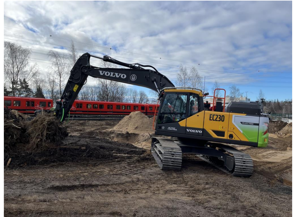
Kuva 3: Volvo EC230 sähkökaivinkone Helsingin kaupungin työmaalla (Kuva: Volvo)
